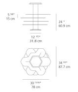
standard length min. 19 <sup>3/4</sup>" - max. 78 <sup>3/4</sup>" min. 50 cm - max. 200 cm
